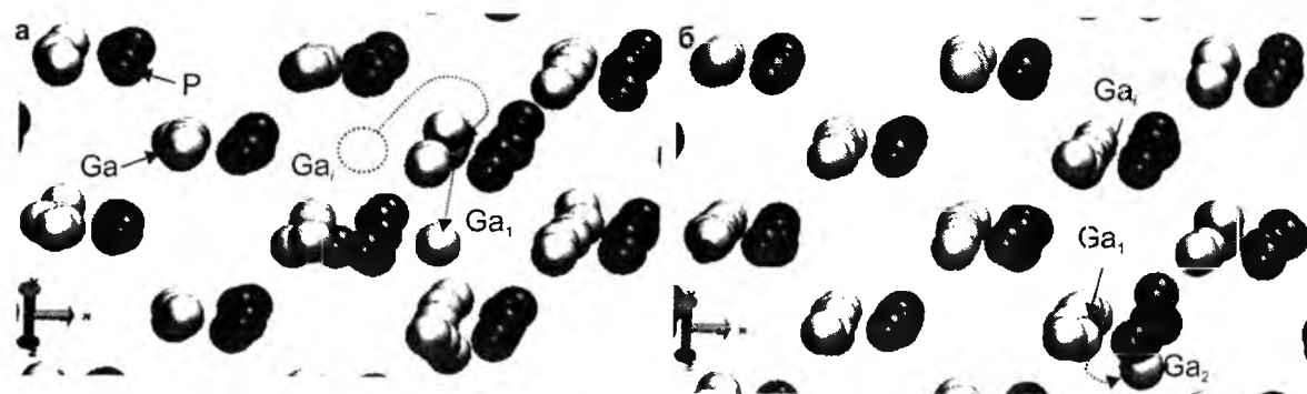
Рис. 4. Рух міжвузлового атома Ga i по кристалу при T = 500K за час τ = 10 -11 с: а – міжвузловий атом Ga i заміщує атом Ga 1 (перше заміщення); б – міжвузловий атом Ga 1 заміщує атом Ga 2 (друге заміщення).
