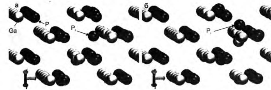
Рис. 1. Рух міжвузлового атома Р, по кристалу при T = 1 К: а – вихідне положення атома Р; б – положення міжвузлового атома Р, яке він зайняв за час \tau = 10^{-11} с.
