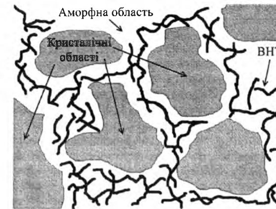
Рис. 3. Схематичне зображення структури систем на основі ПЕГ-10000 при концентрації ВНТ, рівній порогу перколяції (утворення перколяційного кластера).
